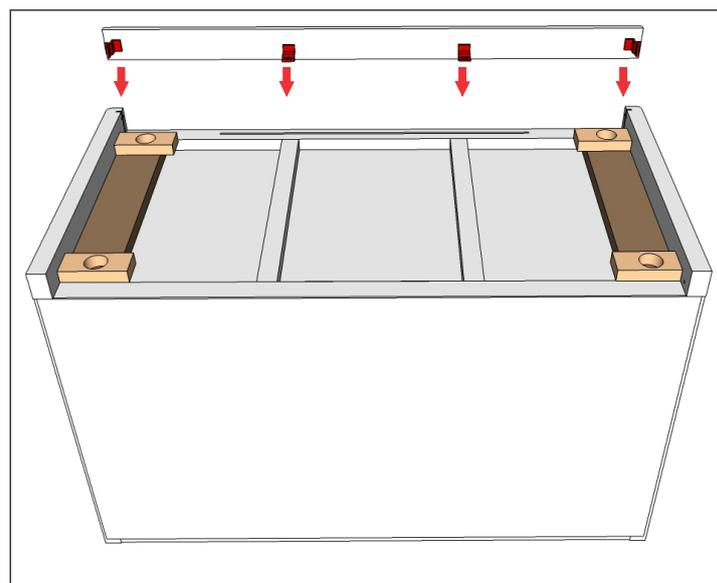
3º Passo - Realize a parafusação da moldura nas furações existentes nas peças.
