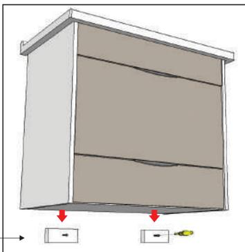
3 Apoie o armário nas madeiras suporte instaladas e realize a parafusação do armário na parede nas cantoneiras já fixadas no armário.
